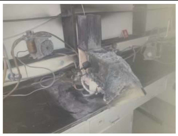
圖 4. 損毀之火焰光度計背面 爆出點燃燒爆炸後先燒毀儀器上方、上方萬向排氣罩及後方之實驗檯面
