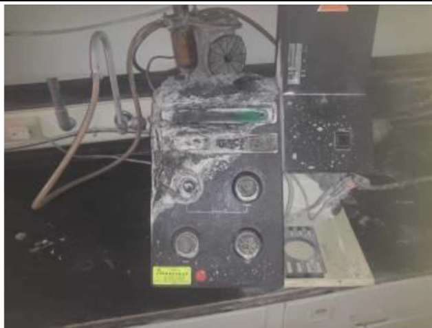
圖 3. 損毀之火焰光度計正面
